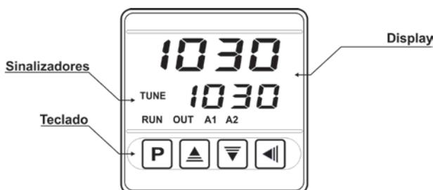
Fig. 02 - Identificação do painel frontal
