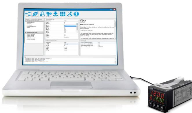
A configuração dos controladores e indicadores da **NOVUS** está muito mais simples. O software configurador NConfig permite realizar de forma simples e rápida a configuração de todos os parâmetros do instrumento.
