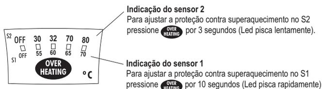
O led sempre mostra a configuração do Sensor S2. Para consultar a configuração do Sensor S1, pressione brevemente o botão **OVER HEATING**, o led irá piscar rapidamente no valor correspondente.
