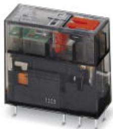
Relé miniatura plugável, com contato de potência, 2 contatos reversíveis, botão de teste, indicação de posição de ligação mecânica, LED de estado, tensão de bobina 120 V AC
