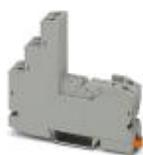
Base de relé RIF-1..., para relé de potência miniatura com 1 ou 2 contatos reversíveis ou relés de estado sólido com o mesmo formato, conexão a parafuso, possibilidade de encaixe para módulos de entrada/módulos supressores, para montagem no NS 35/7,5
