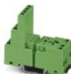
Base para relé PR2-B, para relé industrial REL-IR com 2 ou 4 inversores, versão 1/3 níveis, conexões a parafuso, possibilidade de encaixe para módulos de entrada/contra falhas, para montagem sobre NS 35/7,5
