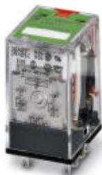
Steckbare Industrirelais mit Leistungskontakten, 2 Wechsler, Prüftaste, Status-LED, mechanische Schaltstellungsanzeige, Eingangsspannung 120 V AC
