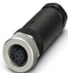
Conector, 8-pólos, Soquete reto M12, codificação A, Conexão a parafuso, material serrilhado: Fundição de zinco sob pressão, niquelado, Prensa-cabos Pg9, Diâmetro externo do cabo 6 mm ... 8 mm
