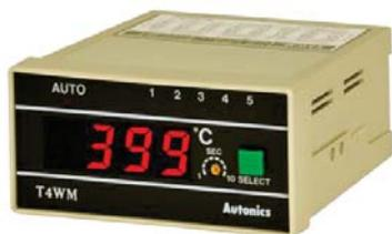
A Série T4WM é um indicador de temperatura digital de até 5 zonas de temperatura com entrada para sensores de temperatura J, K ou Pt100. Melhor visibilidade pelo seu amplo display de 7 segmentos e leds de alto brilho. Não possui nenhum tipo de saída. Monitoramento de alta precisão 0.5%. Troca de visualização no display automática ou manual.
