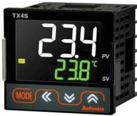
A Série TX é um controlador de temperatura digital com display de LCD que permite melhor visualização por vários ângulos diferentes, alta performance com controle PID com entrada para sensores de temperatura J, K, L, T, R, S e Pt100. Tempo de ciclo rápido de 50ms. Saídas SSR, Relé e Corrente 4-20mA selecionável no código do produto. Tamanho compacto com 45 mm de profundidade. Grau de proteção IP50 (frontal).
