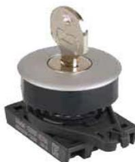
Corpo plástico, seletora com chave e anti-chama, atende a norma EN60947-5-1, contato NF com ruptura positiva, capacidade dos contatos AC-15: 10A 110VAC ou 5A 220VAC.
