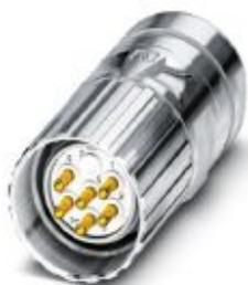
Conector de encaixe para cabos, CA, reto, blindado: sim, Travamento parafusado, M23, Número de pólos: 8+1, tipo de contato: Pino, Conexão soldável, faixa de diâmetro de cabo: 3 mm ... 14,5 mm
