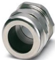
Conexão metálica até 5 bar, comprimento de rosca: 8 mm, diâmetro de cabo: 27 ... 34 mm, SW 50, conexão: M40
