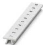
Tira Zack, Fitas, branco, identificado, identificável com: CMS-P1-PLOTTER, impresso horizontalmente: números consecutivos 1 ... 10, 11 ... 20 etc. até 491 ... 500, tipo de montagem: travamento em ranhura elevada de plaqueta, para a largura de terminal: 6,2 mm, tamanho para gravação: 6,15 x 10,5 mm, Quantidade de plaquetas de identificação: 10
