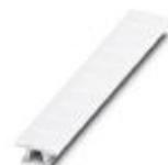
Tira Zack, Fitas, branco, não impresso, identificável com: PLOTMARK, CMS-P1-PLOTTER, tipo de montagem: travamento em ranhura elevada de plaqueta, para a largura de terminal: 6,2 mm, tamanho para gravação: 6,15 x 10,5 mm, Quantidade de plaquetas de identificação: 10
