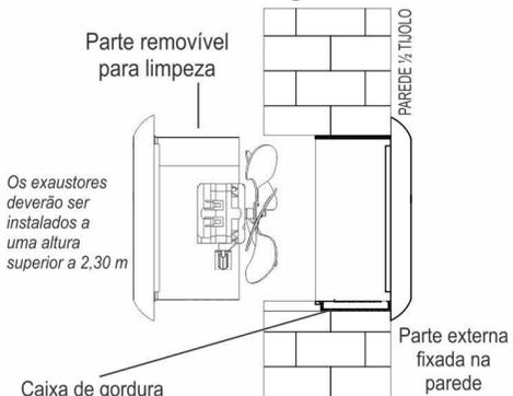
Esse aparelho necessita das seguintes dimensões para ser fixado à parede:
