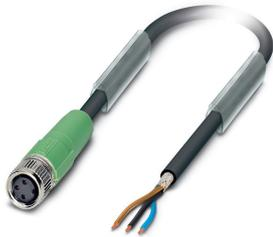
Cabo sensor/atuador, 3-pólos, PUR livre de halogênio, preto acinzentado RAL 7021, blindado, extremidade livre do condutor, para Soquete reto M8, comprimento de cabo: 1,5 m
