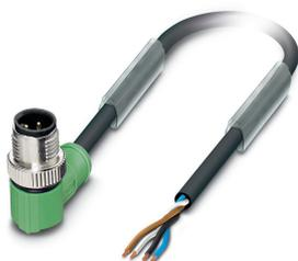
Cabo sensor/atuador, 4-pólos, PUR livre de halogênio, preto acinzentado RAL 7021, Conector angular M12 SPEEDCON, codificação: A, para extremidade livre do condutor, comprimento de cabo: 5 m
