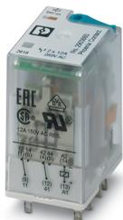
Relé industrial plugável com contatos de potência, 2 contatos reversíveis, botão de teste, LED de estado, diodo de roda livre, indicação de posição de ligação mecânica, polaridade A1+, A2-, tensão de entrada 24 V DC
