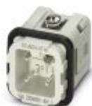
Inserto de contato, número de polos: 3+PE, tamanho: D7, quantidade de conexões por polo: 1, Pino, Conexão a parafuso, 230 V/400 V, 16 A, 0,5 mm<sup>2</sup> ... 2,5 mm<sup>2</sup>
