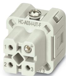
Inserto de contato, número de polos: 3+PE, tamanho: D7, quantidade de conexões por polo: 1, Soquete, Conexão a parafuso, 230 V/400 V, 16 A, 0,5 mm<sup>2</sup> ... 2,5 mm<sup>2</sup>
