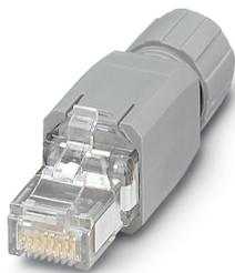
Conector RJ45, grau de proteção: IP20, número de polos: 8, 1 GBit/s, CAT5 (IEC 11801:2002), material: PA, tipo de conexão: Conexão rápida IDC, bitola de conexão: AWG 26- 23, saída de cabo: reto, cor: cinza A RAL 7042
