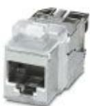
Elemento de soquete RJ45, formato: RJ45, grau de proteção: IP20, número de polos: 8, 10 GBit/s, CAT6<sub>A</sub>, material: Fundição injetada de zinco, tipo de conexão: Conexão IDC, bitola de conexão: AWG 26-22, Versão Keystone para utilização com moldura de montagem IP20 ou integração direta na parede da caixa
