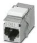
Elemento de soquete RJ45, grau de proteção: IP20, número de polos: 8, 1 GBit/s, CAT6, material: Fundição injetada de zinco, tipo de conexão: Contatos de solda por onda, Keystone
