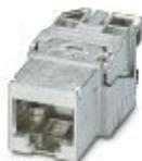
Elemento de soquete RJ45, formato: RJ45, grau de proteção: IP20, número de polos: 8, 10 GBit/s, CAT6<sub>A</sub>, material: Fundição injetada de zinco, tipo de conexão: Conexão IDC, bitola de conexão: AWG 26- 22, saída de cabo: reto, Versão sem adaptador
