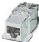
Elemento de soquete RJ45, formato: RJ45, grau de proteção: IP20, número de polos: 8, 10 GBit/s, CAT6<sub>A</sub>, material: Fundição injetada de zinco, tipo de conexão: Conexão IDC, bitola de conexão: AWG 26- 22, Versão Freenet para utilização com moldura de montagem IP67 e saídas de terminais
