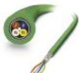
Cabo de rede, PROFINET CAT5 (100 MBit/s), 4-pólos, PVC, verde RAL 6018, blindado, extremidade livre do condutor, para extremidade livre do condutor, comprimento de cabo: Entrada livre (0,5 ... 400 m)
