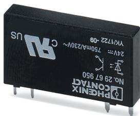
Relé de estado sólido miniatura plugável, relé de estado sólido de potência, 1 contato normalmente aberto, entrada: 24 V DC, saída: 24-253 V AC/0,75 A
