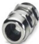
Conexão para cabos, material da conexão: Latão, niquelado, diâmetro externo do cabo 5 mm ... 10 mm, blindagem: sim, rosca de conexão: Pg11, cor: prata, com anel "O"
