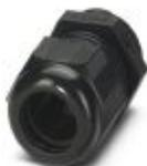
Conexão para cabos, material da conexão: PA, diâmetro externo do cabo 5 mm ... 10 mm, blindagem: não, rosca de conexão: Pg11, cor: preto RAL 9005
