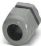
Conexão para cabos, material da conexão: PA, diâmetro externo do cabo 5 mm ... 10 mm, blindagem: não, rosca de conexão: Pg11, cor: cinza prateado RAL 7001
