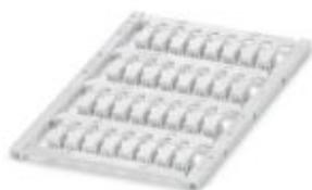
Identificação de condutores e cabos, Folha, branco, não impresso, identificável com: TOPMARK NEO, TOPMARK LASER, BLUEMARK ID COLOR, BLUEMARK ID, BLUEMARK CLED, THERMOMARK PRIME, THERMOMARK CARD 2.0, THERMOMARK CARD, tipo de montagem: encaixar, faixa de diâmetro de cabo: 2 ... 2,9 mm, tamanho para gravação: 12 x 4 mm, Quantidade de plaquetas de identificação: 32
