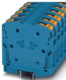
Terminal de alta corrente, tensão nominal: 1000 V AC / 1500 V DC, corrente nominal: 150 A, tipo de conexão: Conexão Power-Turn, quantidade de conexões: 2, número de polos: 1, perfil de conexão: 10 mm<sup>2</sup> - 70 mm<sup>2</sup>, AWG: 8 - 2/0, largura: 20 mm, cor: azul, tipo de montagem: NS 35/15
