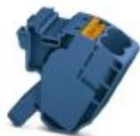
Borne para detector, Para utilizar com os bornes de alta corrente Power-Turn PTPOWER 50, 95,150 e 185, tensão nominal: 1500 V, corrente nominal: 57 A, tipo de conexão: Conexão Push-in, quantidade de conexões: 2, perfil de conexão: 0,5 mm<sup>2</sup> - 16 mm<sup>2</sup>, AWG: 20 - 6, largura: 18,5 mm, altura: 34,7 mm, cor: azul, tipo de montagem: na base
