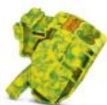
Borne para detector, Para utilizar com os bornes de alta corrente Power-Turn PTPOWER 50, 95,150 e 185, tensão nominal: 1500 V, corrente nominal: 57 A, tipo de conexão: Conexão Push-in, quantidade de conexões: 2, perfil de conexão: 0,5 mm<sup>2</sup> - 16 mm<sup>2</sup>, AWG: 20 - 6, largura: 18,5 mm, altura: 34,7 mm, cor: verde/amarelo, tipo de montagem: na base
