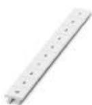
Tira Zack, Fitas, branco, identificado, identificável com: CMS-P1-PLOTTER, impressão vertical: números consecutivos 1 ... 10, 11 ... 20 etc. até 91 ... 100, tipo de montagem: travamento em ranhura elevada de plaqueta, para a largura de terminal: 10,2 mm, tamanho para gravação: 10,15 x 10,5 mm, Quantidade de plaquetas de identificação: 10
