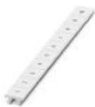
Tira Zack, Fitas, branco, identificado, identificável com: CMS-P1-PLOTTER, impresso horizontalmente: números consecutivos 1 ... 10, 11 ... 20 etc. até 91 ... 100, tipo de montagem: travamento em ranhura elevada de plaqueta, para a largura de terminal: 10,2 mm, tamanho para gravação: 10,15 x 10,5 mm, Quantidade de plaquetas de identificação: 10
