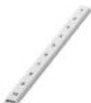
Tira Zack plana, Fitas, branco, identificado, impressão vertical: números consecutivos 1 ... 10, 11 ... 20 etc. até 91 ... 100, tipo de montagem: travamento em ranhura plana de plaqueta, para a largura de terminal: 10 mm, tamanho para gravação: 5,15 x 10 mm, Quantidade de plaquetas de identificação: 10
