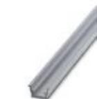
Trilho de fixação não perfurado, Perfil padrão, largura: 35 mm, altura: 15 mm, semelhante à EN 60715, material: alumínio, sem revestimento, comprimento: 2000 mm, cor: cores prat.
