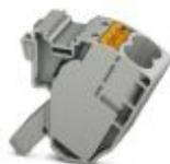
Borne para detector, Para utilizar com os bornes de alta corrente Power-Turn PTPOWER 50, 95,150 e 185, tensão nominal: 1500 V, corrente nominal: 57 A, tipo de conexão: Conexão Push-in, quantidade de conexões: 2, perfil de conexão: 0,5 mm<sup>2</sup> - 16 mm<sup>2</sup>, AWG: 20 - 6, largura: 18,5 mm, altura: 34,7 mm, cor: cinza, tipo de montagem: na base
