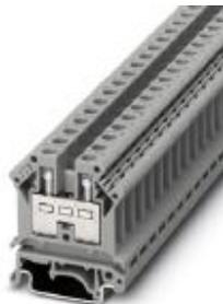
Borne de passagem, tensão nominal: 800 V, corrente nominal: 57 A, tipo de conexão: Conexão a parafuso, quantidade de conexões: 2, perfil de conexão: 0,5 mm<sup>2</sup> - 10 mm<sup>2</sup>, AWG: 20 - 8, largura: 8,2 mm, cor: cinza, tipo de montagem: NS 35/7,5, NS 35/15
