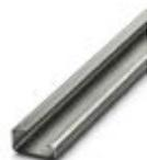
Trilho de fixação não perfurado, Perfil G, largura: 32 mm, altura: 15 mm, de acordo com EN 60715:, material: Aço, galvanizado, bicromatizado, comprimento: 2000 mm, cor: cores prat.
