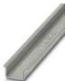
Trilho de fixação não perfurado, Perfil padrão de 2,3 mm, largura: 35 mm, altura: 15 mm, de acordo com EN 60715., material: Aço, galvanizado, bicromatizado, comprimento: 2000 mm, cor: cores prat.
