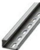
Trilho de fixação perfurado, Perfil G, largura: 32 mm, altura: 15 mm, de acordo com EN 60715:, material: Aço, galvanizado, bicromatizado, comprimento: 2000 mm, cor: prata
