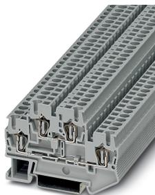
Borne à mola de dois níveis, tipo de conexão: conexão à mola, perfil de conexão: 0,08 mm<sup>2</sup> - 4 mm<sup>2</sup>, AWG: 28 - 12, largura: 5,2 mm, cor: cinza, tipo de montagem: NS 35/7,5, NS 35/15
