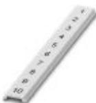
Tira Zack plana, Fitas, branco, identificado, impressão vertical: números consecutivos 1 ... 10, 11 ... 20 etc. até 91 ... 100, tipo de montagem: travamento em ranhura plana de plaqueta, para a largura de terminal: 5 mm, tamanho para gravação: 5,15 x 5,15 mm, Quantidade de plaquetas de identificação: 10
