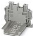
Suporte terminal para montagem rápida, para trilho de fixação NS 35/7,5 ou trilho de fixação NS 35/15, com possibilidade de marcação, com possibilidade de fixação para FBS...5, FBS...6, KSS 5, KSS 6, largura: 5,15 mm, cor: cinza
