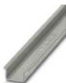
Trilho de fixação não perfurado, Perfil padrão de 2,3 mm, largura: 35 mm, altura: 15 mm, de acordo com EN 60715., material: Aço, galvanizado, bicromatizado, comprimento: 2000 mm, cor: cores prat.
