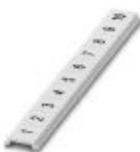
Tira Zack plana, Fitas, branco, identificado, impresso horizontalmente: números consecutivos 1 ... 10, 11 ... 20 etc. até 491 ... 500, tipo de montagem: travamento em ranhura plana de plaqueta, para a largura de terminal: 5 mm, tamanho para gravação: 5,15 x 5,15 mm, Quantidade de plaquetas de identificação: 10
