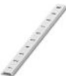
Tira Zack plana, Fitas, branco, identificado, impresso horizontalmente: números consecutivos 1 ... 10, 11 ... 20 etc. até 101 ... 110, tipo de montagem: travamento em ranhura plana de plaqueta, para a largura de terminal: 8 mm, tamanho para gravação: 5,15 x 8,15 mm, Quantidade de plaquetas de identificação: 10
