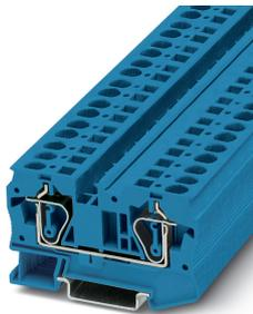
Borne de passagem, tensão nominal: 1000 V, corrente nominal: 41 A, tipo de conexão: conexão à mola, quantidade de conexões: 2, perfil de conexão: 0,2 mm<sup>2</sup> - 10 mm<sup>2</sup>, AWG: 24 - 8, largura: 8,2 mm, cor: azul, tipo de montagem: NS 35/7,5, NS 35/15
