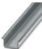
Trilho de fixação não perfurado, Perfil padrão, largura: 35 mm, altura: 15 mm, semelhante à EN 60715, material: Aço, galvanizado, comprimento: 2000 mm, cor: cores prat.
