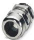
Conexão para cabos, material da conexão: Latão, niquelado, diâmetro externo do cabo 5 mm ... 10 mm, blindagem: sim, rosca de conexão: Pg11, cor: prata, com anel "O"
