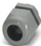
Conexão para cabos, material da conexão: PA, diâmetro externo do cabo 5 mm ... 10 mm, blindagem: não, rosca de conexão: Pg11, cor: cinza prateado RAL 7001
