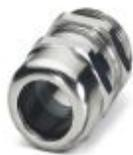
Conexão para cabos, material da conexão: Latão, niquelado, diâmetro externo do cabo 5 mm ... 10 mm, blindagem: não, rosca de conexão: Pg11, cor: prata, com anel "O"
