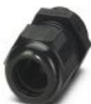
Conexão para cabos, material da conexão: PA, diâmetro externo do cabo 5 mm ... 10 mm, blindagem: não, rosca de conexão: Pg11, cor: preto RAL 9005
