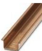
Trilho de fixação não perfurado, Perfil padrão, largura: 35 mm, altura: 15 mm, semelhante à EN 60715, material: Cobre, sem revestimento, comprimento: 2000 mm, cor: cobre
