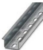
Trilho de fixação perfurado, Perfil padrão, largura: 35 mm, altura: 15 mm, semelhante à EN 60715, material: Aço, galvanizado, comprimento: 2000 mm, cor: cores prat.
