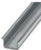
Trilho de fixação não perfurado, Perfil padrão, largura: 35 mm, altura: 15 mm, semelhante à EN 60715, material: Aço, galvanizado, comprimento: 2000 mm, cor: cores prat.
