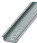
Trilho de fixação não perfurado, Perfil padrão, largura: 35 mm, altura: 7,5 mm, de acordo com EN 60715:, material: Aço, galvanizado, com passivação em branco, comprimento: 2000 mm, cor: cores prat.
