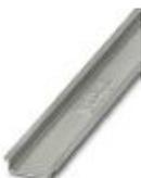
Trilho de fixação não perfurado, Perfil padrão, largura: 35 mm, altura: 7,5 mm, de acordo com EN 60715:, material: Aço, galvanizado, bicromatizado, comprimento: 2000 mm, cor: cores prat.
