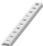
Tira Zack plana, Fitas, branco, identificado, impresso horizontalmente: números consecutivos 1 ... 10, 11 ... 20 etc. até 91 ... 100, tipo de montagem: travamento em ranhura plana de plaqueta, para a largura de terminal: 6,2 mm, tamanho para gravação: 5,15 x 6,15 mm, Quantidade de plaquetas de identificação: 10
