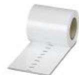
Marcador de terminais, Rolo, branco, não impresso, identificável com: THERMOMARK ROLL 2.0, THERMOMARK ROLL, THERMOMARK ROLL X1, THERMOMARK ROLLMASTER 300/600, THERMOMARK X1.2, THERMOMARK S1.1, perfurado, tipo de montagem: travamento em ranhura para plaqueta universal, travamento em ranhura plana de plaqueta, para a largura de terminal: 6,2 mm, tamanho para gravação: 6,35 x 6,15 mm, Quantidade de plaquetas de identificação: 16000
