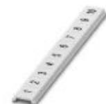
Tira Zack plana, Fitas, branco, identificado, impresso horizontalmente: números consecutivos 1 ... 10, 11 ... 20 etc. até 491 ... 500, tipo de montagem: travamento em ranhura plana de plaqueta, para a largura de terminal: 5 mm, tamanho para gravação: 5,15 x 5,15 mm, Quantidade de plaquetas de identificação: 10
