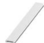
Tira Zack plana, disponível para pedido: em tiras, branco, identificado conforme dados do cliente, tipo de montagem: travamento em ranhura plana de plaqueta, para a largura de terminal: 5 mm, tamanho para gravação: 5,15 x 5,15 mm, Quantidade de plaquetas de identificação: 10
