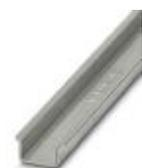
Trilho de fixação não perfurado, Perfil padrão de 2,3 mm, largura: 35 mm, altura: 15 mm, de acordo com EN 60715., material: Aço, galvanizado, bicromatizado, comprimento: 2000 mm, cor: cores prat.
