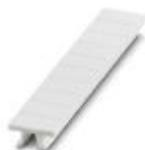
Tira Zack, Fitas, branco, não impresso, identificável com: PLOTMARK, CMS-P1-PLOTTER, tipo de montagem: travamento em ranhura elevada de plaqueta, para a largura de terminal: 5,2 mm, tamanho para gravação: 5,1 x 10,5 mm, Quantidade de plaquetas de identificação: 10
