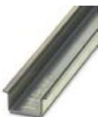
Trilho de fixação não perfurado, Perfil padrão, largura: 35 mm, altura: 15 mm, semelhante à EN 60715, material: Aço, galvanizado, bicromatizado, comprimento: 2000 mm, cor: cores prat.
