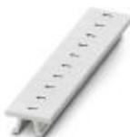
Tira Zack, Fitas, branco, identificado, identificável com: CMS-P1-PLOTTER, impresso horizontalmente: números iguais 1 ou 2 etc. até 100, tipo de montagem: travamento em ranhura elevada de plaqueta, para a largura de terminal: 5,2 mm, tamanho para gravação: 5,15 x 10,5 mm, Quantidade de plaquetas de identificação: 10
