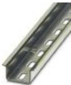
Trilho de fixação perfurado, Perfil padrão, largura: 35 mm, altura: 15 mm, semelhante à EN 60715, material: Aço, galvanizado, bicromatizado, comprimento: 2000 mm, cor: cores prat.
