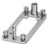
Placa de adaptador para suportes, para contatos macho/fêmea da forma construtiva B16, com 4 parafusos de cabeça plana M5, compensação do suporte eixo x/y  $\pm 1,5$  mm
