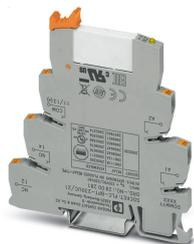
PLC-INTERFACE, composta de terminal básico PLC-BPT.../21 com conexão push-in e relé miniatura plugável com contato de potência, para montagem sobre trilho de fixação NS 35/7,5, 1 contato reversível, tensão de entrada 230 V AC/220 V DC
