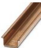
Trilho de fixação não perfurado, Perfil padrão, largura:35 mm, altura:15 mm, semelhante à EN 60715, material:Cobre, sem revestimento, comprimento:2000 mm, cor:cobre
