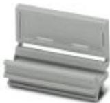
Placa de identificação de grupos, encaixável no centro do terminal para terminais de conexão por rosqueamento, por mola de tração e rápida, identificável com tiras de encaixe ESL 26 x 6 mm ou EST 25 x 6 mm, no pé com tira Zack, comprimento: 29 mm
