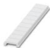
Tira Zack plana, disponível para pedido: em tiras, branco, identificado conforme dados do cliente, tipo de montagem: travamento em ranhura plana de plaqueta, para a largura de terminal: 3,5 mm, tamanho para gravação: 3,5 x 5,2 mm, Quantidade de plaquetas de identificação: 10
