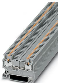
Borne de passagem, tensão nominal: 500 V, corrente nominal: 17,5 A, tipo de conexão: Conexão Push-in, quantidade de conexões: 2, perfil de conexão: 0,14 mm<sup>2</sup> - 1,5 mm<sup>2</sup>, AWG: 26 - 14, largura: 3,5 mm, altura: 30,5 mm, cor: cinza, tipo de montagem: NS 35/7,5, NS 35/15
