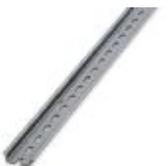
Trilho de fixação perfurado, Perfil padrão, largura:35 mm, altura:7,5 mm, de acordo com EN 60715:, material:Aço, galvanizado, com passivação em branco, comprimento:2000 mm, cor:cores prat.
