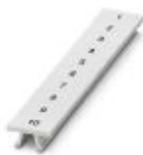
Tira Zack, Fitas, branco, identificado, identificável com: CMS-P1-PLOTTER, impressão vertical: números consecutivos 1 ... 10, 11 ... 20 etc. até 491 ... 500, tipo de montagem: travamento em ranhura elevada de plaqueta, para a largura de terminal: 6,2 mm, tamanho para gravação: 6,15 x 10,5 mm, Quantidade de plaquetas de identificação: 10
