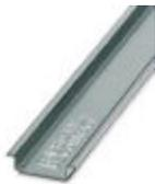
Trilho de fixação não perfurado, Perfil padrão, largura:35 mm, altura:7,5 mm, de acordo com EN 60715:, material:alumínio, sem revestimento, comprimento:2000 mm, cor:cores prat.
