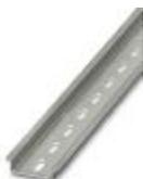
Trilho de fixação perfurado, Perfil padrão, largura:35 mm, altura:7,5 mm, de acordo com EN 60715:, material:Aço, galvanizado, bicromatizado, comprimento:2000 mm, cor:prata
