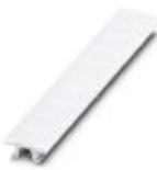
Marcador de terminais, Fitas, branco, identificado, identificável com: CMS-P1-PLOTTER, longitudinal: L1, L2, L3, N, PE, L1, L2, L3, N, PE, tipo de montagem: travamento em ranhura elevada de plaqueta, para a largura de terminal: 6,2 mm, tamanho para gravação: 6,15 x 10,5 mm, Quantidade de plaquetas de identificação: 10
