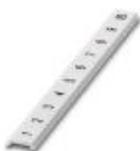
Tira Zack plana, Fitas, branco, identificado, impresso horizontalmente: números consecutivos 1 ... 10, 11 ... 20 etc. até 91 ... 100, tipo de montagem: travamento em ranhura plana de plaqueta, para a largura de terminal: 6,2 mm, tamanho para gravação: 5,15 x 6,15 mm, Quantidade de plaquetas de identificação: 10
