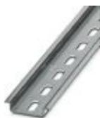
Trilho de fixação perfurado, Perfil padrão, largura:35 mm, altura:7,5 mm, de acordo com EN 60715:, material:Aço, galvanizado, comprimento:2000 mm, cor:cores prat.
