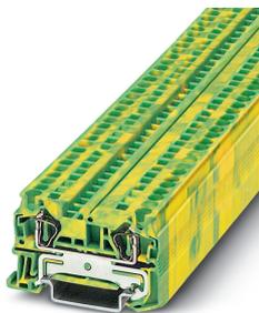
Borne de proteção à mola, tipo de conexão: conexão à mola, quantidade de conexões: 2, perfil de conexão: 0,08 mm<sup>2</sup> - 6 mm<sup>2</sup>, AWG: 28 - 10, largura: 6,2 mm, cor: verde-amarelo, tipo de montagem: NS 35/7,5, NS 35/15
