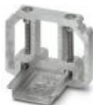
Base, para suporte terminal de UKH 50 a UKH 240, é deslocado sobre o trilho de fixação NS 35 e fixado com 2 parafusos, largura: 10 mm, cor: alumínio
