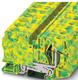
Borne terra modular, tipo de conexão: conexão à mola, quantidade de conexões: 2, perfil de conexão: 2,5 mm<sup>2</sup> - 35 mm<sup>2</sup>, AWG: 14 - 2, largura: 16 mm, cor: verde-amarelo, tipo de montagem: NS 35/7,5, NS 35/15
