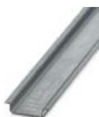
Trilho de fixação não perfurado, Perfil padrão, largura:35 mm, altura:7,5 mm, de acordo com EN 60715:, material:Aço, galvanizado, comprimento:2000 mm, cor:cores prat.
