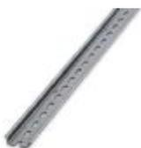
Trilho de fixação perfurado, Perfil padrão, largura:35 mm, altura:7,5 mm, de acordo com EN 60715; material:Aço, galvanizado, com passivação em branco, comprimento:2000 mm, cor:cores prat.
