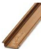
Trilho de fixação não perfurado, Perfil padrão, largura:35 mm, altura:7,5 mm, de acordo com EN 60715:, material:Cobre, sem revestimento, comprimento:2000 mm, cor:cobre
